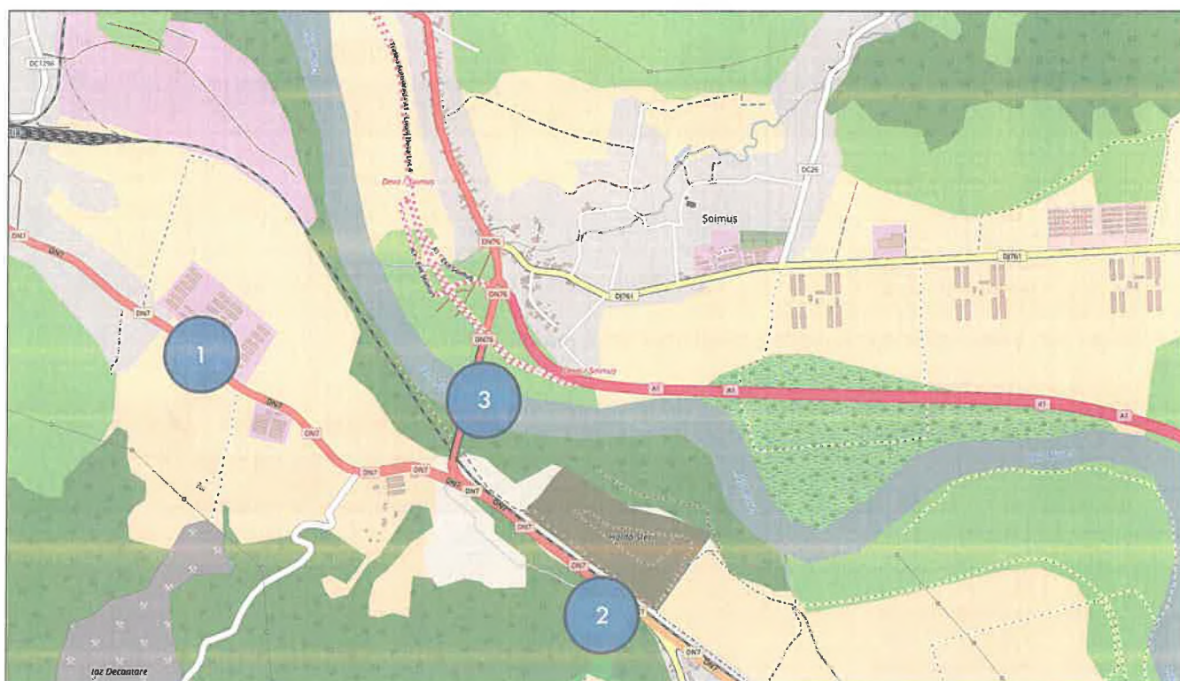
Figura 3.2 Codificarea relațiilor de trafic după reamenajarea intersecției
